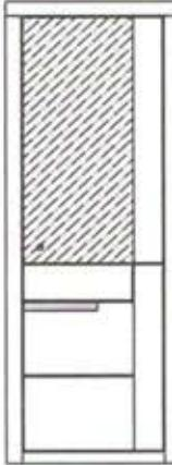
Type 11     | <p><b>4141 10 / 4141 11</b></p> <p><b>Vitrine</b><br/>1 Glastür, 1 SK Vollauszug, 1 Holztür</p> <p>2 Glasböden, 1 Holzboden</p> <p>Türanschanlag links = Type 10<br/>Türanschlag rechts = Type 11</p> <p>→ LED-Beleuchtung (2xLED55, 1 Trafo) bitte separat bestellen<br/>(auf Wunsch mit Funk-Set)</p> | 71 / 203 / 40             |                            |                        |                                     |                                  |
