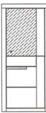
Type 11A | <p><b>4141 10A / 4141 11A</b></p> <p><b>Vitrine</b><br/>1 Glastür, 1 SK, 1 Holztür</p> <p>1 Glasboden, 1 Holzboden</p> <p>Türanschlag links = Type 10A<br/>Türanschlag rechts = Type 11A</p> <p>→ LED-Beleuchtung (1xLED55, 1 Trafo)<br/>bitte separat bestellen<br/>(auf Wunsch mit Funk-Set)</p>      | 71 / 170 / 40             |                            |                        |                                     |                                  |
